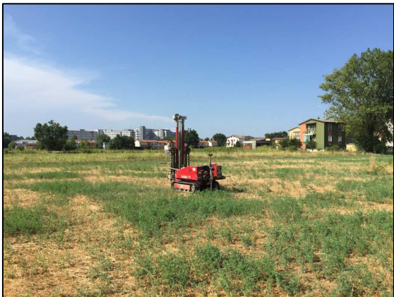
Prova penetrometrica statica (CPT) n.3.
