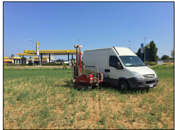
Prova penetrometrica statica (CPT) n.2.
