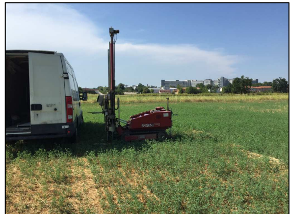
Prova penetrometrica statica (CPT) n.4.
