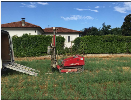
Prova penetrometrica statica (CPT) n.1.
