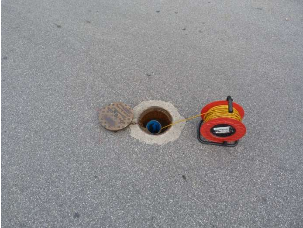
Piezometro monitoraggio ambientale (id.27)
