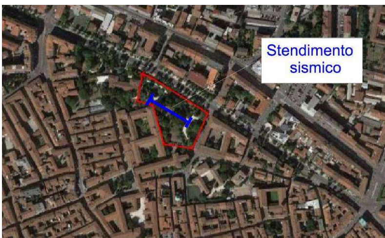
Figg. 5.21-22 Indagine sismica MASW presso il sito 12 Giardino Vecchio Passeggio, via Gioconda
