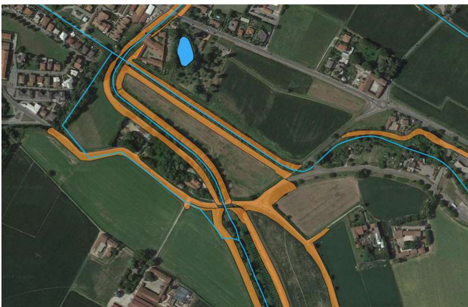
Fig. 25 Aree golenali associabili alle “aree tra le sponde” per la loro stretta connessione al corso d’acqua (in giallo gli argini che le limitano)
