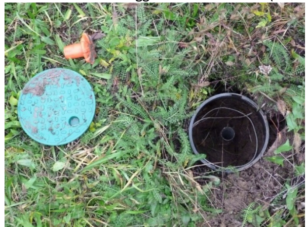
Piezometro indagine Cimitero Cremona (id.19)
