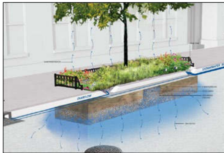
Struttura di un'aiuola verde in ambito urbano. La corretta progettazione di filari e aiuole verdi in contesto urbano deve tener conto di alcuni fattori fondamentali, come la disponibilità di acqua (eventuali scoli o tombini) in relazione alle esigenze della vegetazione in termini di apporto idrico e di spazio a disposizione per lo sviluppo vegetale. In caso di specie adatte a terreni asciutti e ben drenati dovrà essere previsto anche un idoneo sistema di deflusso dell'acqua.
