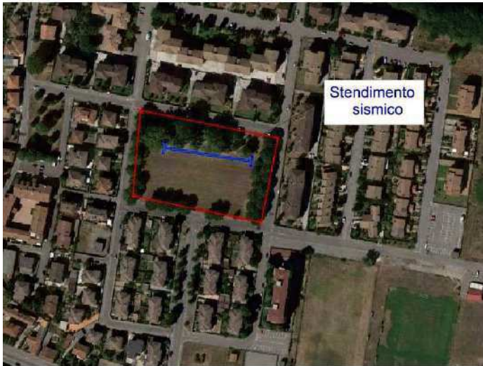
Figg. 5.19-20 Indagine sismica MASW eseguita presso il sito 11 Giardini Cavatigozzi di via Zana
