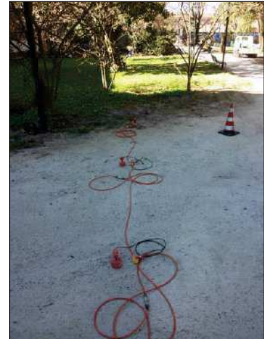
Figg. 5.21-22 Indagine sismica MASW presso il sito 12 Giardino Vecchio Passeggio, via Gioconda
