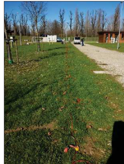
Figg. 5.13-14 Indagine sismica MASW eseguita presso il sito 1 Nuovo Campeggio di via del Sale
