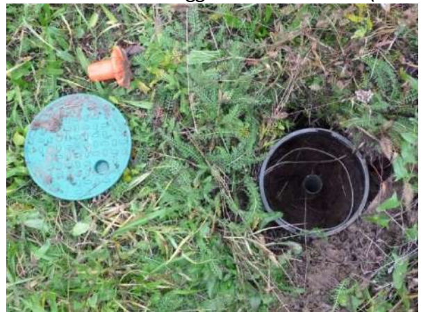
Piezometro indagine Cimitero Cremona (id.19)
