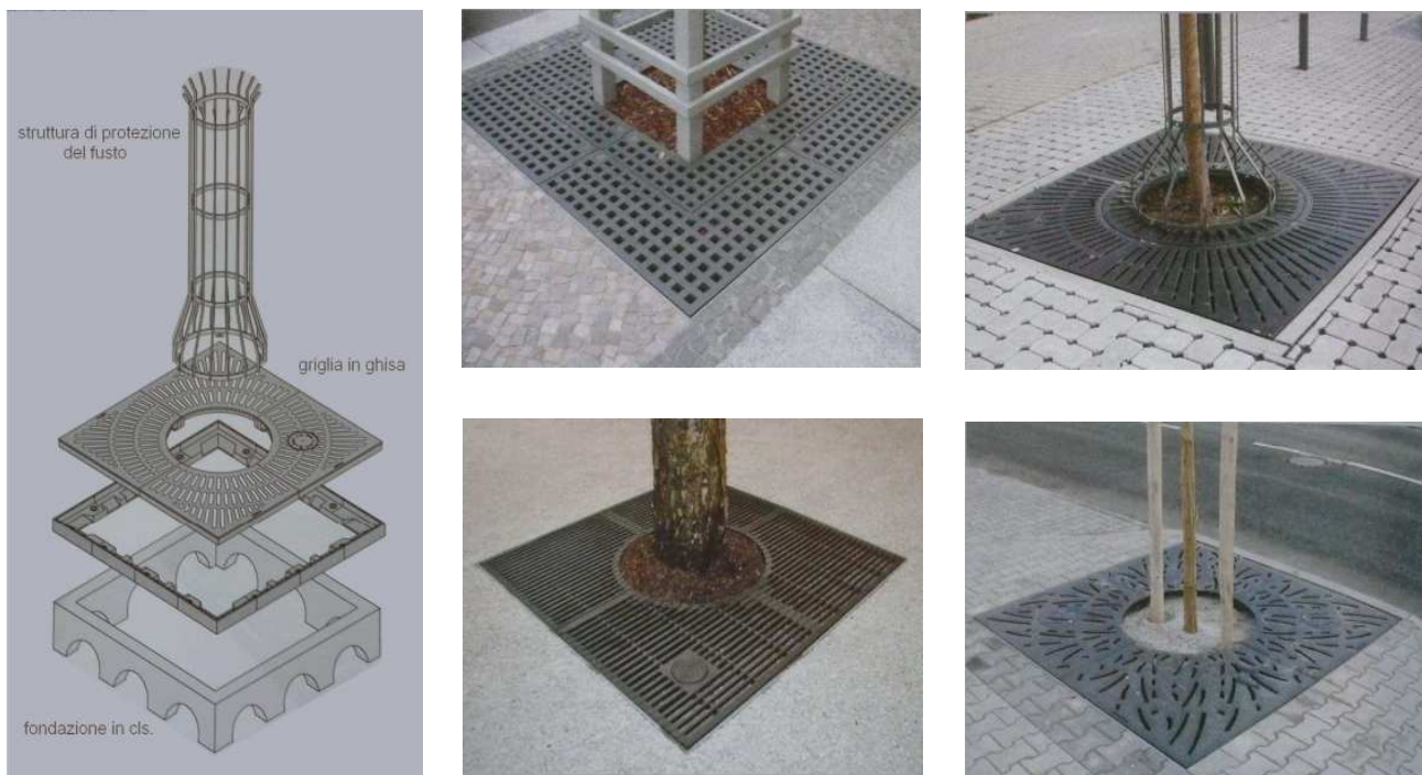
Illustrazione 9: esempio di protezione a raso per alberature (Reg. Verde Comune di Parma)
