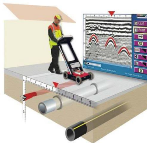
Esempio: Indagine georadar di sottoservizi
