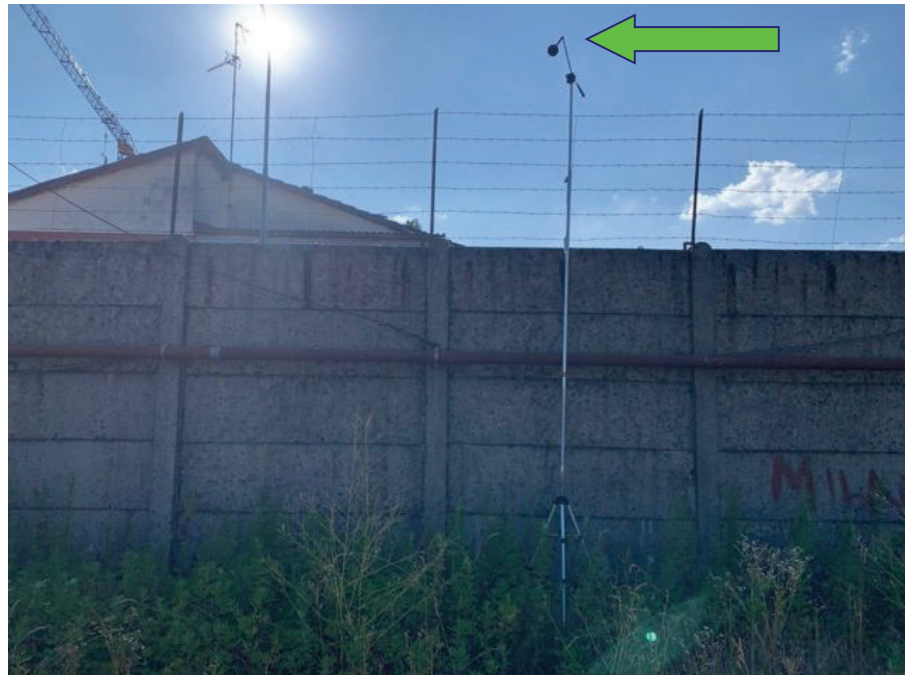
Dettaglio punto di misura A (stazione fissa 24h)
